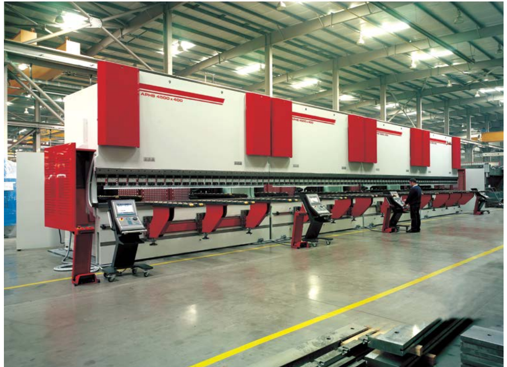
Στραντζόπρεσα CNC 1600tn και μήκους 18000mm
