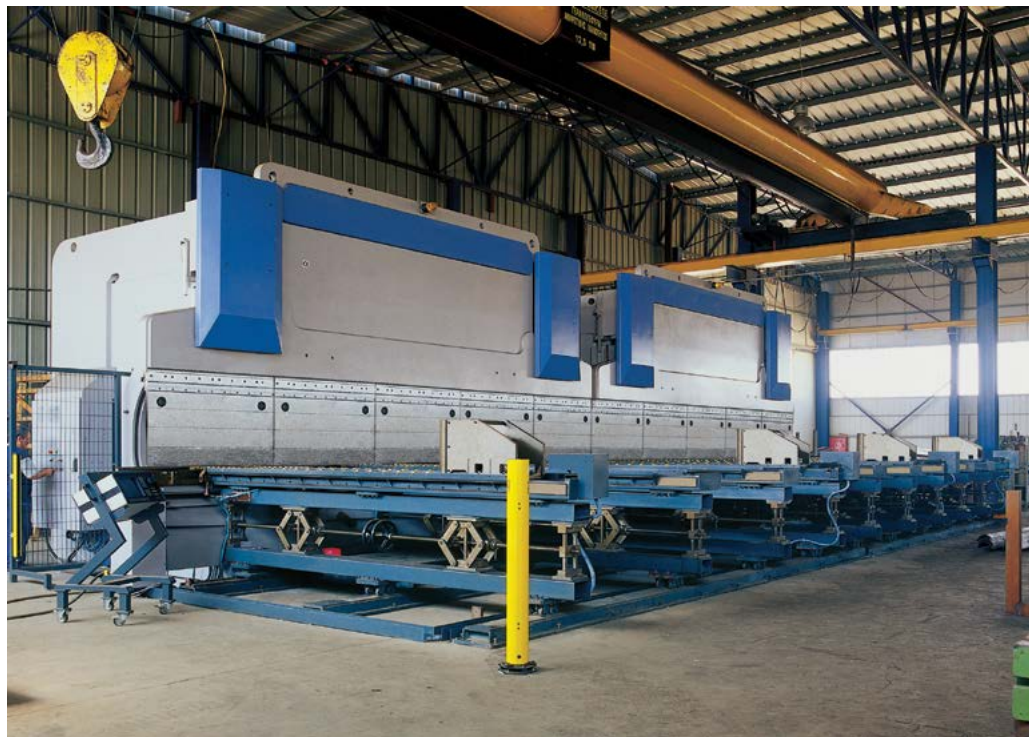
Στραντζόπρεσα CNC 1400tn και μήκους 14000mm
